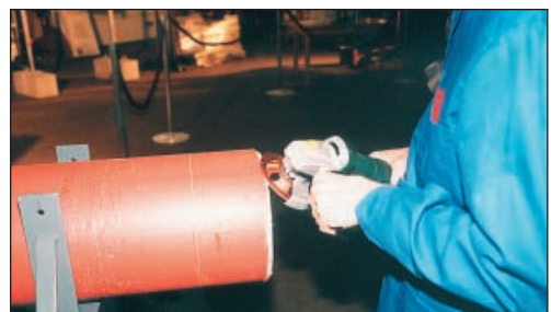
(zobrazení 30) zkosení trubek rašplovým kotoučem
